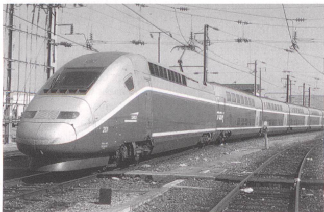
Bild 8 TGV-Duplex, Doppelstockwagen mit Jakobsdrehgestell der SNCF ( v_{\max} = 300 \text{ km/h} , 385 t, 377 Sitzplätze) (Bild: La Vie du Rail)
