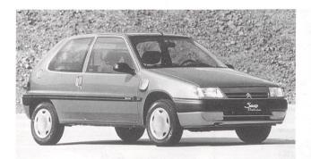
Der Saxo électrique von Citroën (links) und der 106 électrique von Peugeot (rechts) sind vom Antrieb her identisch und unterscheiden sich nur in der Karosserie. Neuerdings werden sie auch als Viertürer angeboten. Sie sind mit Gleichstrommotoren und Nickel/Cadmium-Batterien der französischen Firma Saft – Garantie vier Jahre – ausgerüstet. Peugeot bietet den 106 neu auch mit Batteriemiete an.
