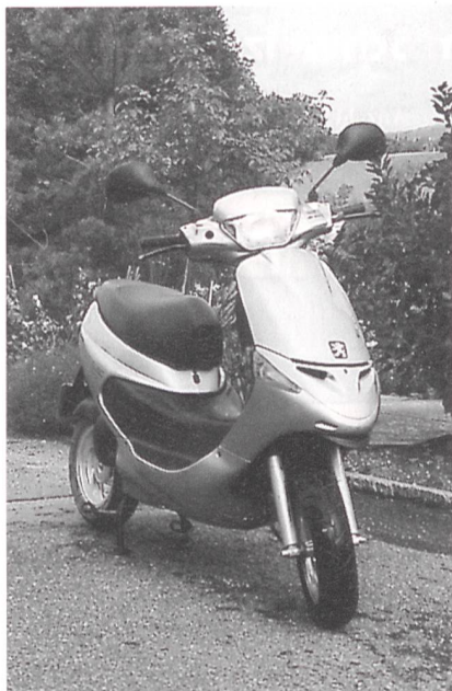
Scoot'elec von Peugeot. Der erfolgreiche Elektroller zeichnet sich durch ausgezeichnete Fahrleistungen in der Stadt aus. Höchstgeschwindigkeit 50 km/h, Reichweite rund 40 bis gegen 60 km, einfache Bedienung, Ladedauer etwa 2 Stunden.
