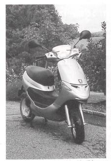
Scoot'elec von Peugeot. Der erfolgreiche Elektroroller zeichnet sich durch ausgezeichnete Fahrleistungen in der Stadt aus. Höchstgeschwindigkeit 50 km/h, Reichweite rund 40 bis gegen 60 km, einfache Bedienung, Ladedauer etwa 2 Stunden.
