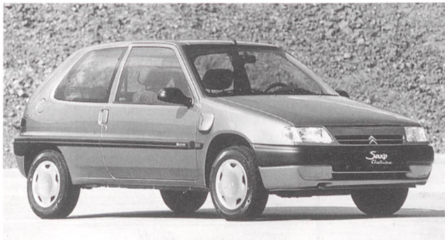
Der Saxo électrique von Citroën (links) und der 106 électrique von Peugeot (rechts) sind vom Antrieb her identisch und unterscheiden sich nur in der Karosserie. Neuerdings werden sie auch als Viertürer angeboten. Sie sind mit Gleichstrommotoren und Nickel/Cadmium-Batterien der französischen Firma Saft – Garantie vier Jahre – ausgerüstet. Peugeot bietet den 106 neu auch mit Batteriemiete an.
