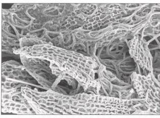
Bild 13 Elektronenmikroskopische Aufnahme der in einem Verschmutzungsstreifen enthaltenen Flechten.
