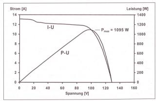
Bild 7 Auf STC umgerechnete *U-I-* und *P-U-*Kennlinien sowie MPP-Leistung eines ungereinigten Arrays der PV-Anlage der HTA Burgdorf (4 parallele Stränge von je 6 Modulen M55 in Serie) nach fünf Betriebsjahren (gemessen im Juni 1998). Der Wendepunkt auf der *U-I-*Kennlinie ist ein typisches Merkmal bei dieser Verschmutzung.
