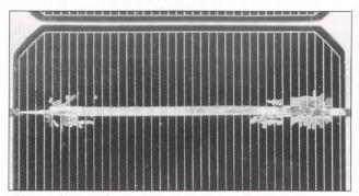
Bild 14 Ende 1998 aufgenommene Delaminationen bei einem etwa neunjährigen monokristallinen Solarmodul (Produktionsjahr 1989).
