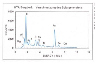
Bild 12 Analyse der Zusammensetzung des verschmutzenden Materials: Eine dispersive Mikro-Röntgenaufnahme zeigt die wichtigsten anorganischen Komponenten.
