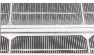
Bild 4 Detailansicht des relativ kompakten, etwa 1 cm breiten Verschmutzungsstreifens an der Modul-Unterkante (Detail von Bild 3).
