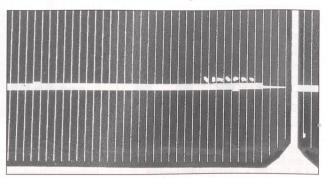
Bild 15 Ende 1998 aufgenommene beginnende Delaminationen bei einem neueren monokristallinen Solarmodul (Produktionsjahr 1993).
