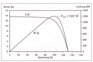
Bild 8 Auf STC umgerechnete *U-I*- und *P-U*-Kennlinien sowie MPP-Leistung des Arrays von Bild 7 nach der Reinigung.
