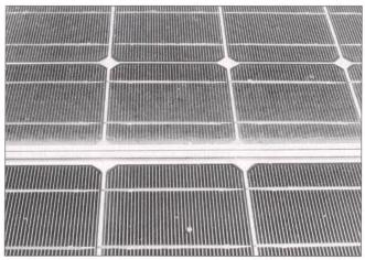
Bild 3 Verschmutzungsstreifen an der Unterkante eines gerahmten Moduls Siemens M55 (längere Seite in horizontaler Position gemäss Bild 2).
