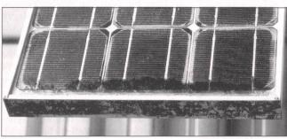
Bild 5 Auch bei steiler angestellten, hochkant montierten Modulen können derartige Verschmutzungsstreifen auftreten. Beim gezeigten Modul ist der Anstellwinkel 65°.
