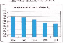
Bild 9 Verlauf der Generatorleistung in Funktion der Zeit: Generator-Korrekturfaktor  $k_{\rm G}$  in den drei Sommermonaten der Jahre 1994 bis 1997 und im Mai 1998.  $k_{\rm G}$  sinkt zunächst langsam, dann nach Entwicklung biologischer Aktivität rascher ab ( $k_{\rm G}=Y_{\rm s}/Y_{\rm T}$ , siehe [3]).
