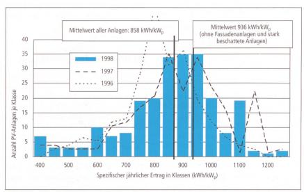
Bild 2 Die spezifischen Erträge der Photovoltaikanlagen 1998 in Kilowattstunden pro installiertes Kilowatt (kWh/kWp), aufgeteilt in 50-kWh/kWp-Klassen. Der Mittelwert liegt bei rund 858 kWh/kWp. Als Vergleich sind die Kurven der Vorjahre 1996 und 1997 aufgezeichnet.
