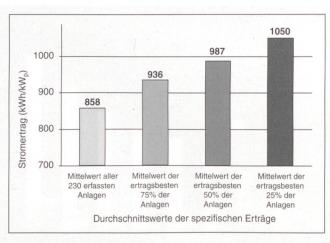
Bild 3 Mittelwerte der spezifischen Erträge. Die Graphik zeigt, dass bei Vernachlässigung der Anlagen mit geringer Produktion (überdurchschnittliche Beschattung, Fassadenanlage usw.) der Mittelwert der spezifischen Erträge stark ansteigt. Heutzutage liefern Solarstromanlagen ohne schwerwiegende Störfaktoren 900 kWh/kWp und mehr.
