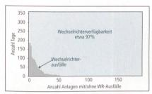
Bild 6 Die Verfügbarkeit der Wechselrichter betrug 1998 durchschnittlich 97,2%; dies entspricht dem Wert vom Vorjahr. Von den 192 erfassten Anlagen waren 51 Anlagen von Wechselrichterausfällen betroffen, das heisst 26,5% aller Anlagen.
