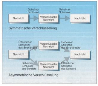
Bild 1 Symmetrische und asymmetrische Verschlüsselungsverfahren
