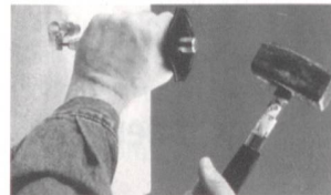
Der Bolzen sitzt fest im robusten Setzwerkzeug.
