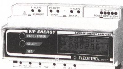
Energieanalysatoren VIP-Energy messen und registrieren genau: V, A, kW, kVar, kVA, cos-phi pro Phase + 3ph; Crestfaktor pro Phase, kWh, -kWh, kVarh, -kVarh pro Phase + 3ph; max. kW, max. kVA 3ph; Datum und Tageszeit. Strom- und Spannungswandler frei wählbar. Optionen mit RS485 Schnittstellen und Ausgangs-Impuls-Relais.
