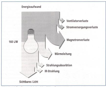
Bild 3 Energieflussdiagramm bei einer Schwefeldampflampe.
