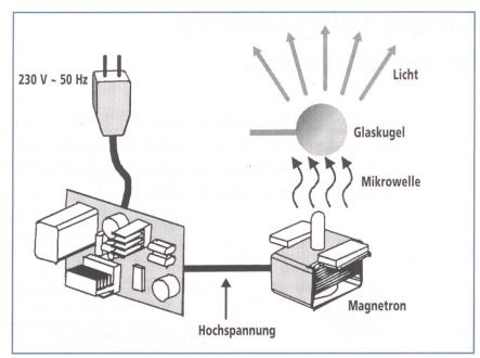
Bild 2 Hauptbestandteile der Schwefeldampflampe.
