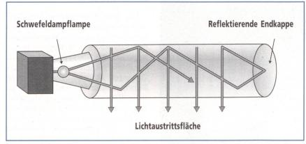
Bild 4 Funktionsprinzip der Light Pipe.
