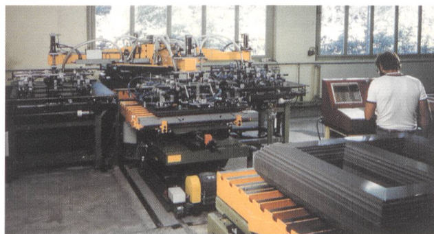
Automatische Schichtanlage für Transformatorkerne
