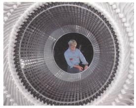
Titelbild: Stator zu Turbogenerator (Photo H.R. Bramaz).
