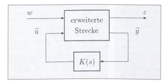
Bild 3 Signalflussbild des H<sub>∞</sub>-Regelsystems
