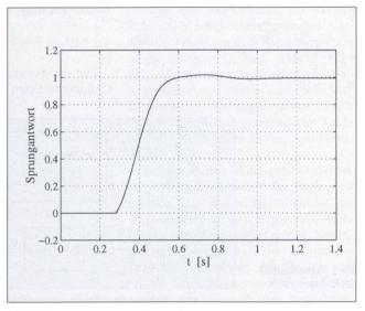
Bild 6 Einheitssprungantwort des Regelsystems
