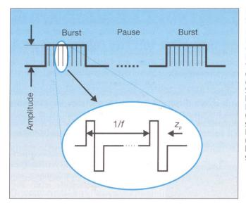
Bild 2 Stimulationsparameter Eine Abfolge von Rechteckimpulsen (Burst) führt zur Muskelkontraktion die folgende Pause erlaubt dem Muskel sich zu erholen. Die Stimulationsfrequenz f bestimmt die Kontraktionsform (glatt, ruckartig, schnelle oder langsame Ermüdung), Amplitude und Pulsbreite (tp) legen die Kontraktionsstärke fest.
