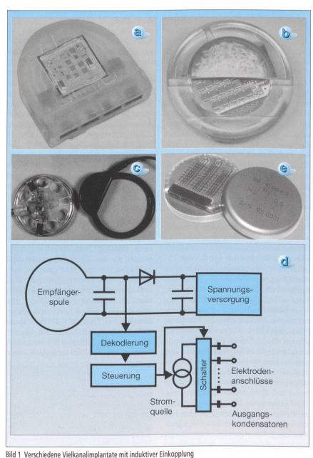
bild i verschiedene vielkanalimpiantate mit induktiver Eliikoppiung
