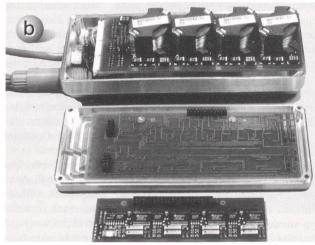
Bild 5 a: Prototyp eines 8-Kanal-Oberflächenstimulationssystems, b: modular aufgebauter 4-Kanal-Stimulator
