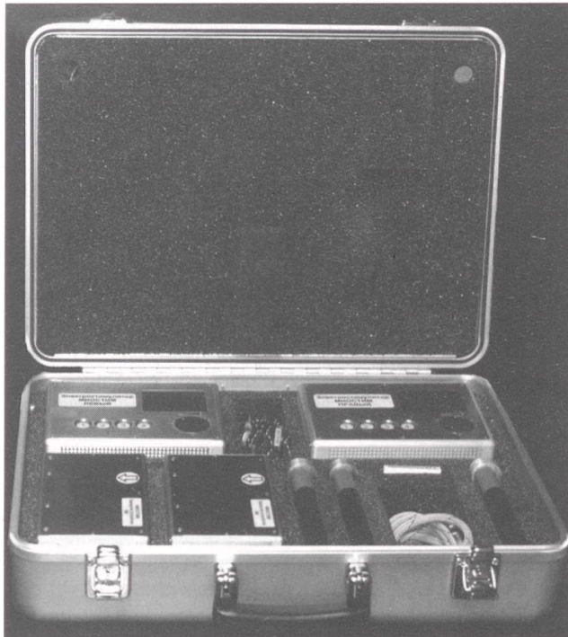
Bild 8 Gerätekofter vor Abflug zur Raumstation MIR: Stimulatoren, Ladegeräte, Akkus, Verbindungskabel
