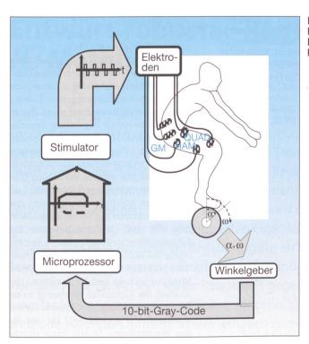
Bild 6 Fahrrad für Paraplegiker: Blockschaltbild des Regelkreises
