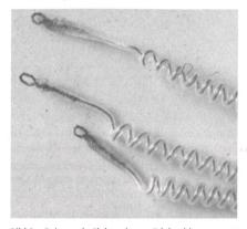
Bild 3 Epineurale Elektrode aus Edelstahl (Stainless steel 316), Durchmesser etwa 0,8 mm
