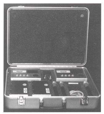
Bild 8 Gerätekoffer vor Abflug zur Raumstation MIR: Stimulatoren, Ladegeräte, Akkus, Verbindungskabel
