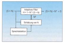
Bild 2 Spektrale Subtraktion / Wienerfilter zur Rauschunterdrückung mit einem Mikrophon
