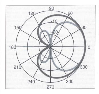
Bild 6 Polardiagramm mit Richtcharakteristiken von zwei Systemen erster und zweiter Ordnung bei der Frequenz 4 kHz. Dunkle Kurve: Kardioid. Helle Kurve: System zweiter Ordnung. Die Dämpfung ist in dB angegeben.
