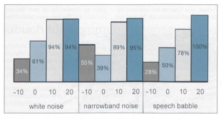
Bild 4 Messung der Klangqualität. Präferenz für das verarbeitete Signal in % der Versuchspersonen bei vier verschiedenen Eingangs-Signal-Rausch-Verhältnissen und drei verschiedenen Störsignalen. Die Daten sind aus [3] entnommen. Weitere Einzelheiten im Text.
