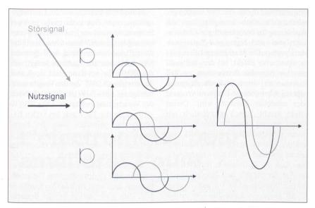
Bild 5 Beispiel zur Dämpfung eines Störsignals, wenn es aus einer anderen Richtung kommt als das Nutzsignal.
