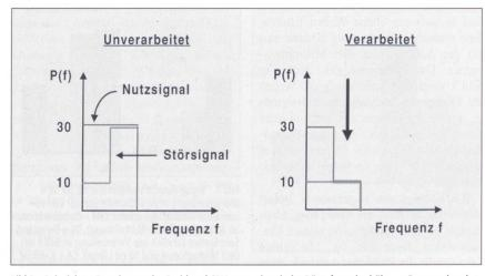
Bild 9 Beispiel zur Berechnung des Breitband-SRV vor und nach der Dämpfung des höheren Frequenzbandes durch ein System mit einem Mikrophon. Einzelheiten im Text.
