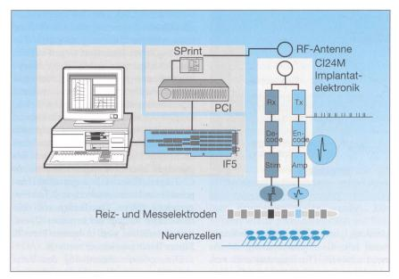
Bild 3 Apparatur zur Messung von neuralen Antworten
