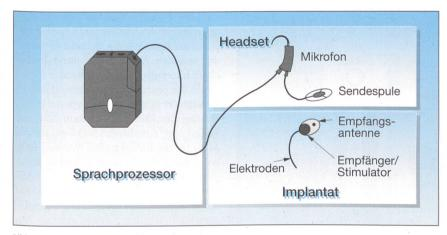
Bild 2 Komponenten eines Cochlear-Implantat-Systems
