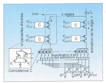
Fig. 16 Schéma d'un processeur flou analogique
