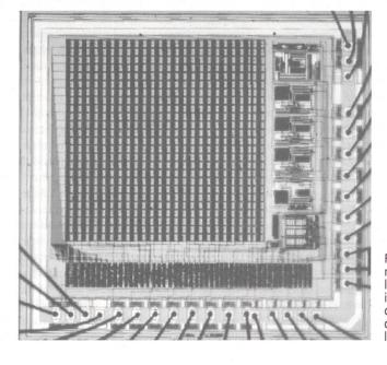
Fig. 8 Réseau VLSI mesurant l'intensité locale maximum d'une image projetée; applicamande d'un écran à cristaux liquides
