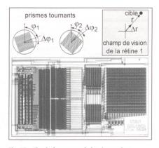
Fig. 15 Circuit de commande incrémentale en boucle fermée; le codage spatial est utilisé pour calculer les rotations élémentaires des prismes correspondant à un déplacement élémentaire de l'axe de vision vers la cible.
