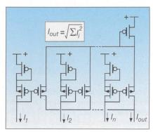
Fig. 3 Calcul de la longueur d'un vecteur (lout) à l'aide de boucles translinéaires formées de transistors MOS travaillant en faible inversion
