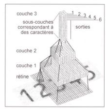
Fig. 11 Architecture d'un système VLSI de reconnaissance optique de caractères
