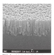
Bild 6 Querschnitt durch eine TiN-Elektrode Die kolumnare Oberflächenmorphologie führt zu grossen Grenzflächenkapazitäten.
