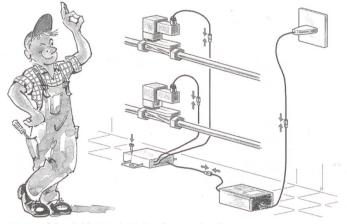
Wasserzufuhr wird bei Feuchtigkeit sofort unterbrochen.
