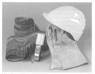
Feldmonitor zur Sicherheit bei Arbeiten in elektromagnetischen Feldern.
