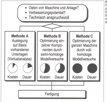
Bild 2 Verfahren zur hydraulischen Entwicklung von Ersatzlaufrädern.
