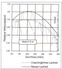
Bild 8 Wirkungsgradvergleich der beiden Laufradgenerationen.
