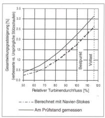
Bild 6 Verbesserung des Gesamtwirkungsgrads infolge der Stützschaufelmodifizierung.
