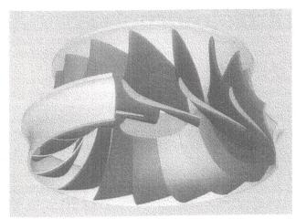
Bild 3 Computergrafik zum Ersatzlaufrad während des Entwicklungsprozesses.
