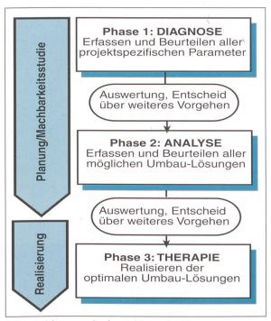
Bild 1 Dreiphasenvorgehen zur Turbinenmodernisierung.
