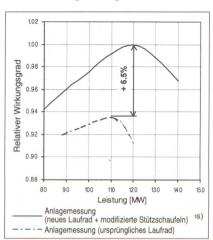
Bild 7 Wirkungsgradvergleich der beiden Laufradgenerationen.
