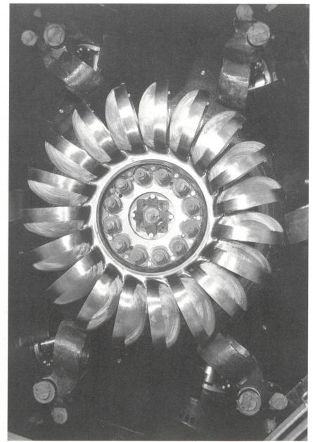
Bild 4 Das montierte Peltonturbinenrad.
