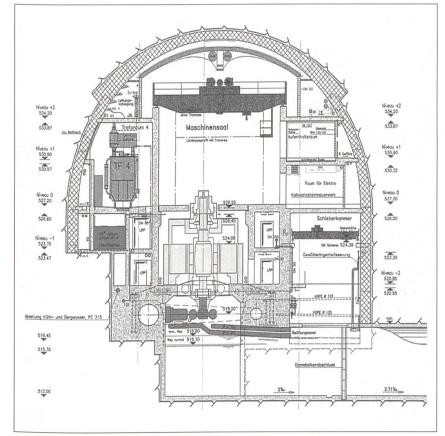
Bild 3 Querschnitt durch die Kavernenzentrale.
