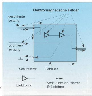
Bild 1 Einkopplungswege elektromagnetischer Felder
