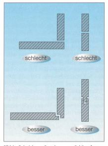
Bild 4 Beispiele zur Gestaltung von Gehäusefugen
