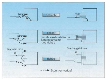
Bild 6 Kontaktierungsarten des Kabelschirms
