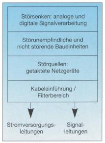
Bild 2 Trennung von Bereichen unterschiedlicher Empfindlichkeit
