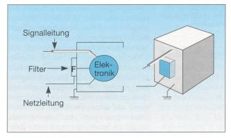
Bild 7 EMV-Gehäuse für den Schutz empfindlicher Elektronik [2]
