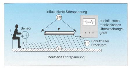
Bild 3 Schematische Darstellung von Wirkungen elektromagnetischer Störungen
