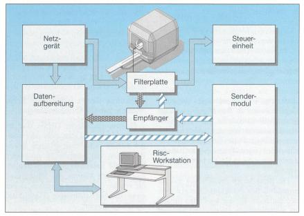
Bild 5 Blockschaltbild eines MRS (Bruker Medspec Avance MR System)
