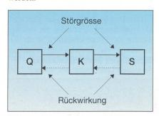
Bild 1 Der Mechanismus der Störbeeinflussung
