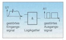
Bild 4 Störung in einem digitalen System
