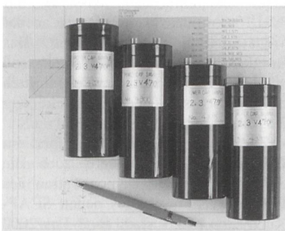
Bild 7 Vier Superkondensator-Elemente, 470 Farad, U_{\max}=2,3V
