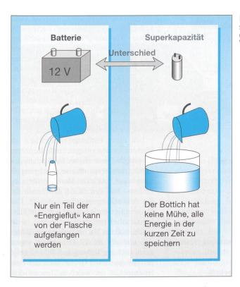
Bild 9 Speichereigenschaft einer Batterie und einer Superkapazität im Vergleich
