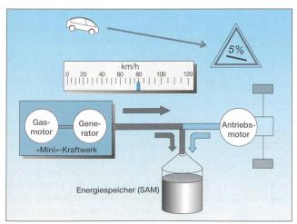
Bild 4 Situation mit Energieüberschuss
