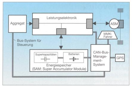
Bild 3 Blockschema des Serie-Hybrid-Antriebs im Blue-Angel
