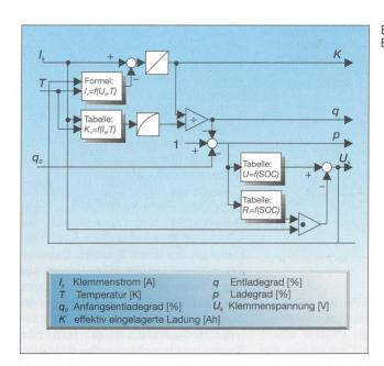
Bild 12 Struktur des Batteriemodells
