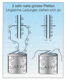
Bild 8 Funktionsprinzip eines Kondensators
