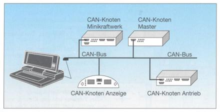
Bild 6 Struktur des CAN-Bus-Management-Systems
