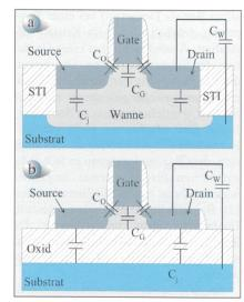
Bild 1 Schematischer Querschnitt eines Mosfets auf reinem Siliziumsubstrat (a) und auf einem SOI-Substrat (b) mit eingezeichneten Kapazitäten
