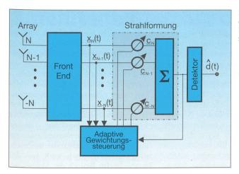
Bild 7 Blockdiagramm einer Smart Antenna im Empfangsteil einer Basisstation
