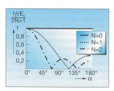
Bild 4 Normalisierte Strahlungscharakteristik eines linearen Antennenarrays mit 2N+1 Elementen
