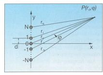
Bild 3 Linearer Antennenarray
