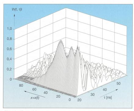
Bild 1 Zeitvariante Kanalstossantwort
