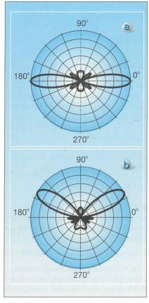
Bild 5 Strahlungscharakteristik  $|\gamma(\varphi)|/E_0$  eines linearen Antennenarrays mit 5 Elementen ( $d=\lambda/2$ )
