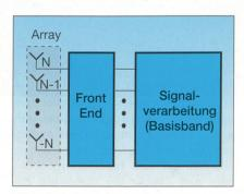
Bild 2 Blockschema eines intelligenten Antennensystems
