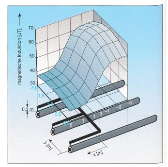
Bild 4 Verteilung der magnetischen Induktion (wie in Bild 3, aber ohne Berücksichtigung der Kurzschlussverbindungen bei der Magnetfeldberechnung)
