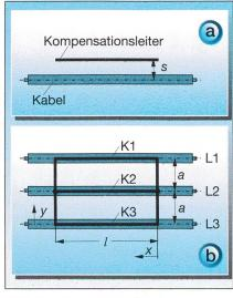
Bild 1 Versuchsanordnung mit drei Kompensationsleitern je Kabelader
