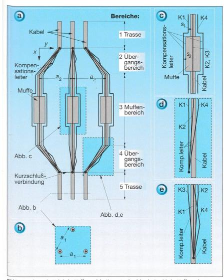
Bild 5 Anordnung der Kabel, der Muffen und der Kompensationsleiter im Bereich der Muffengrube
