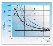
Bild 4 Maximale Übertragungsleistung S der Kabel ohne Bodenaustrocknung als Funktion der Kühlabschnittslänge I
