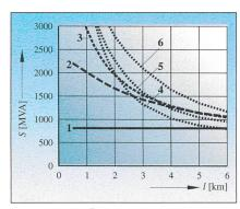
Bild 5 Maximale Übertragungsleistung S der Kabel mit partieller Bodenaustrocknung im normal verfüllten Kabelgraben als Funktion der Kühlabschnittslänge I
