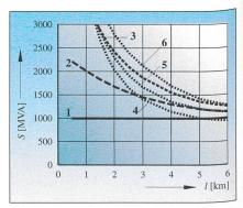
Bild 6 Maximale Übertragungsleistung S der Kabel mit partieller Bodenaustrocknung im thermisch stabilisierten Kabelgraben als Funktion der Kühlabschnittslänge I
