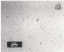
Bild 4 Wasserbäumchen in PE unterschiedlicher Provenienz
