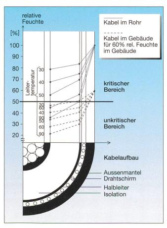
Bild 1 Kritische und unkritische Feuchtigkeit für verschiedene Leitertemperaturen
