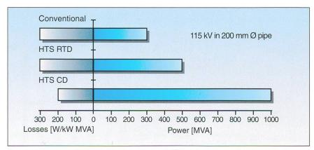
Figure 5 Pertes et capacité de transport d'un câble de 115 kV placé dans une conduite existante de 200 mm Comparaison pour câbles conventionnels et supraconducteurs avec diélectriques à température ambiante (RTD) et froide (CD)
