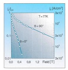
Figure 2 Variation de j<sub>c</sub>(77K) en fonction du champ magnétique pour des rubans multi-filamentaires de Bi,Pb(2223) à 77 K pour les deux orientations  $B_{\parallel}$  et  $B_{\perp}$  à la face du ruban
