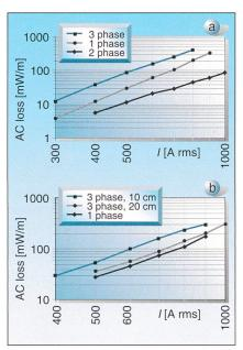
Figure 6 Pertes AC d'un câble prototype en Bi(2223) composé de 2 couches mutuellement isolées
