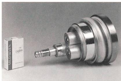
Figure 4 Représentation du câble supraconducteur triphasé de Sumitomo (Japon) avec 100 MVA (66 kV/1000 A)
