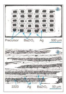
Figure 8 Section d'un ruban de Bi(2223) avec 30 filaments, isolés par une barrière de Ba $ZrO_3$  de  $2~\mu m$  d'épaisseur et une gaine en Ag
