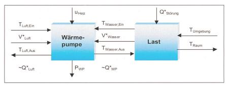
Bild 2 Wärmepumpe mit Last.
