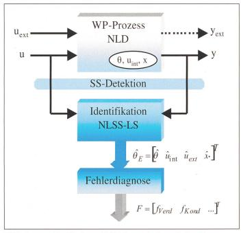
Bild 3 Parameteridentifikation und Fehlerdiagnose in den stationären Phasen.
