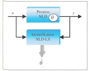
Bild 6 Parameteridentifikation mit Least-Squares-Verfahren in den transienten Phasen.
