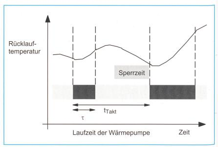
Bild 5 Pulsbreitenmodulation des Stellsignals.
