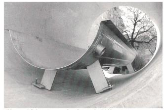
Bild 3 Modell des Wärmetauschers (IBA Stadt Zürich).
