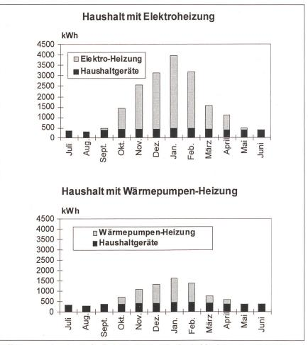
Grafik 1 Stromverbrauch im Einfamilienhaus. Oben ein Gebäude mit Elektroheizung, unten ein Gebäude mit Erdsonden-Wärmepumpe (Grafik Energiefachstelle des Kantons Basel-Land).
