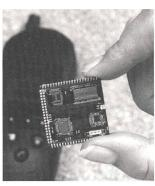
Der GPS-Empfänger MS 1 der Schweizer µ-blox AG ist dermassen klein, dass er problemlos in ein Handy eingebaut werden kann. (Foto Siemens)
