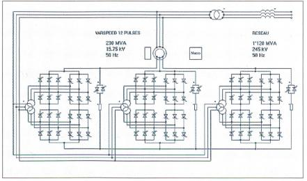
Figure 1 Machine asynchrone dotée d'une cascade cyclo-convertisseur
