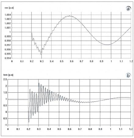
Figure 4 a: Vitesse d'une machine synchrone conventionnelle suite au creux de tension, b: Couple électromagnétique d'une machine synchrone conventionnelle suite au creux de tension
