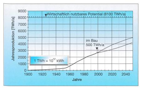
Bild 4 Entwicklung der weltweiten Jahresproduktion der Wasserkraftwerke seit 1900 mit Bandbreite der Ausbauprognosen bis 2050 gemäss Weltenergiekonferenz 1995
