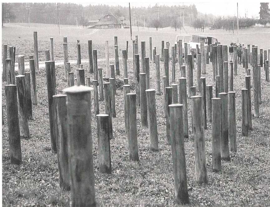
Mastenversuche im Stangengarten der Centralschweizerischen Kraftwerke (CKW) in Rathausen LU (alle Aufnahmen von E. Graf, Abt. Biologie, EMPA St.Gallen).
