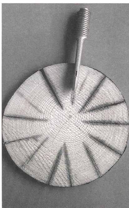
Mastquerschnitt mit Stockschutz und Impfnadel.
