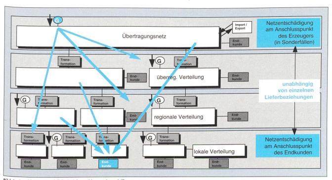
Bild 1 Durchleitungsmodell (Beispiel Anschlusspunktmodell).
