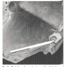
Fig. 2 Etat des pales après six ans d'exploitation Une partie de la matière en queue de pale et de la collerette a disparu. La réparation est effectuée en ressoudant un triangle de métal en acier inox 13/4 et en rechargeant le diamètre extérieur, puis par meulage, le profil est reconstitué.
