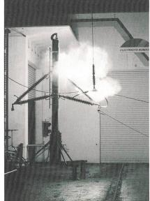
Fig. 4 Suspension Fanion horizontale; à droite: essai de court-circuit
