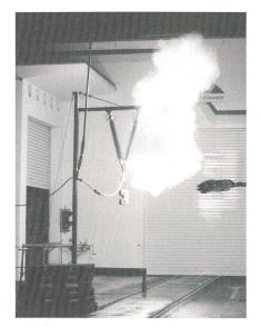
Fig. 3 Suspension Fanion verticale; à droite: essai de court-circuit
