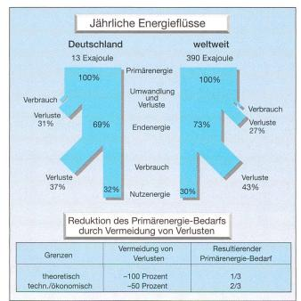
Bild 2 Jährliche Flüsse von Energie von den Energiequellen zum Endverbraucher und Grenzen der Steigerung der Energieeffizienz
