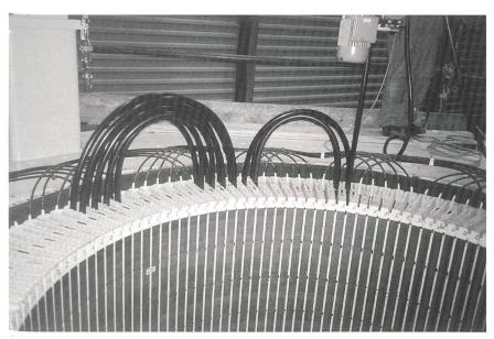
Bild 4 Stator für das Wasserkraftwerk Porjus – hier wird das Kabel durch die Bohrungen geschlauft.
