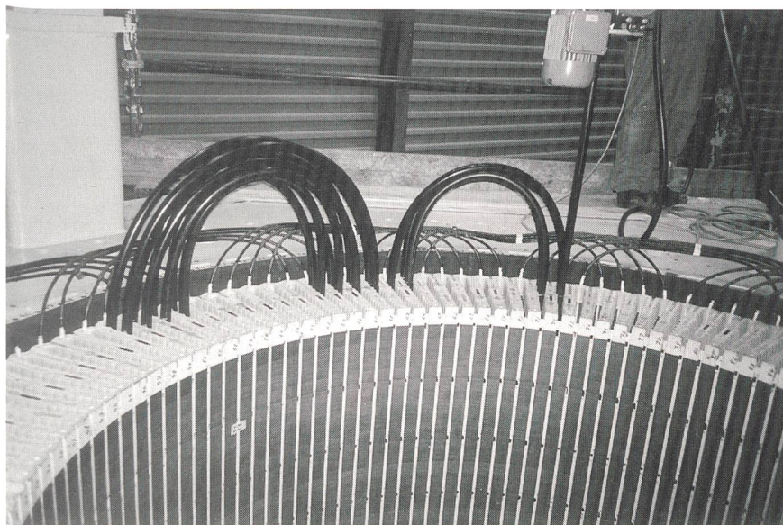
Bild 4 Stator für das Wasserkraftwerk Porjus – hier wird das Kabel durch die Bohrungen geschlauft.
