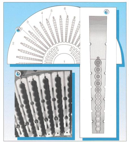
Bild 3 Schnitt durch den Stator eines Powerformers (a), Detail des Stators ohne Kabel (b) und berechnete Temperaturverteilung um die Statornut herum (c), dunkle Töne entsprechen hohen Temperaturen 1 Rotor, 2 Schnitt durch den Stator, 3 Zähne, 4 Nuten, 5 Hauptwicklungskabel, 6 Kabel für Ersatzleistung
