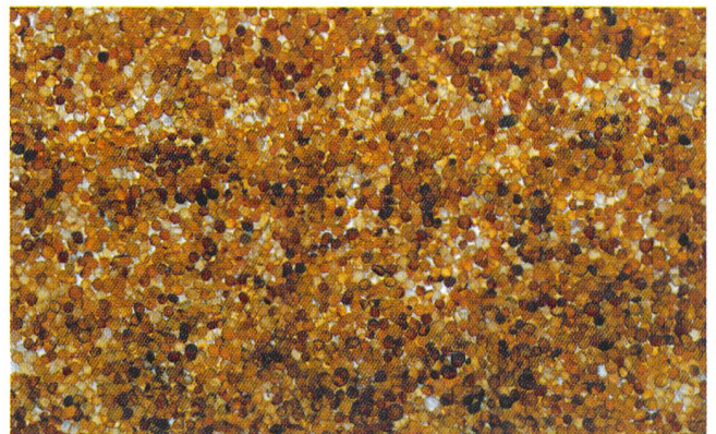
Silikagel entzieht der Luft die Feuchtigkeit.
