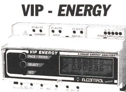
Energieanalysatoren VIP-Energy messen und registrieren genau: V, A, kW, kVar, kVA, cos-phi pro Phase + 3ph; Crestfaktor pro Phase; kWh, -kWh, kVarh, -kVarh pro Phase + 3ph; max. kW, max. kVA 3ph; Datum und Tageszeit. Strom- und Spannungswandler frei wählbar. Optionen mit RS485 Schnittstellen und Ausgangs-Impuls-Relais.
