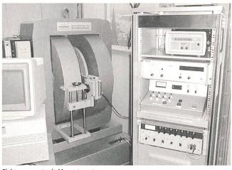
Elektromagnet mit Magnetometer.
