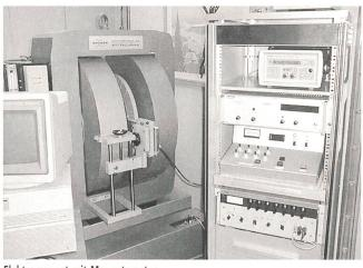
Elektromagnet mit Magnetometer.
