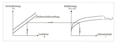
Bild 4 Belastungsabhängige Lüfterregelung.
