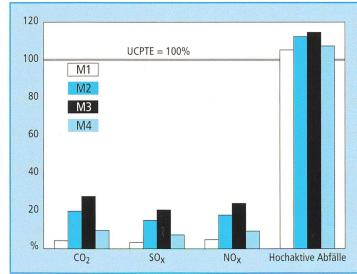
Bild 2 Umwelteinwirkungen der Strommodelle im Verhältnis zum UCPTE-Mix (= 100%), durchschnittliche jährliche Emissionen berechnet nach Frischknecht et al. (1996).
