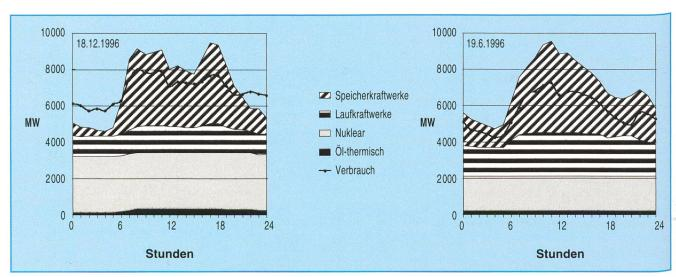
Bild 4 Tageslastkurven eines typischen Winter- und Sommertages; aus VSE (1996).
