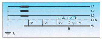
Bild 8 Berührungsspannung bei Vervielfachung des Potentialausgleichs
