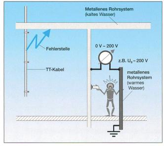
Bild 1 Ohne Potentialausgleich, Spannungsüberbrückung
