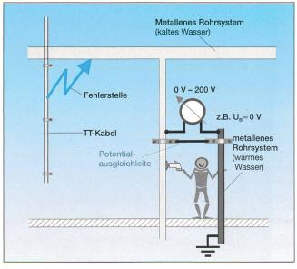
Bild 2 Mit Potentialausgleich, keine Spannungsüberbrückung
