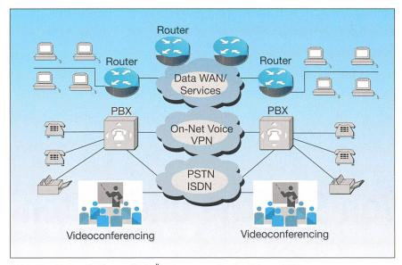
Bild 1 Verschiedene Plattformen für die Übertragung von Sprache, Daten und Bildern
