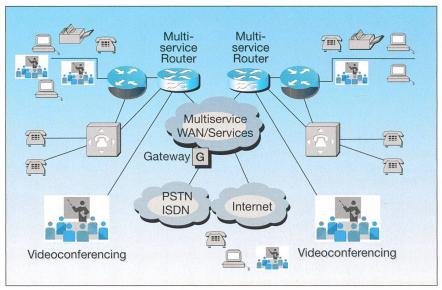
Bild 2 Sämtliche Services werden für die Übertragung über eine einzige Multiservice-Plattform geführt.
